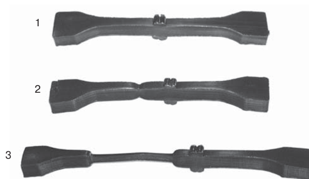
Фото 4.2.9. Образец с фрагментом стыкового сварного соединения (1).
