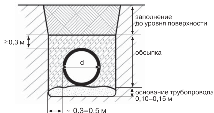
Рис. 4.1. Рекомендуемые параметры профиля траншеи
